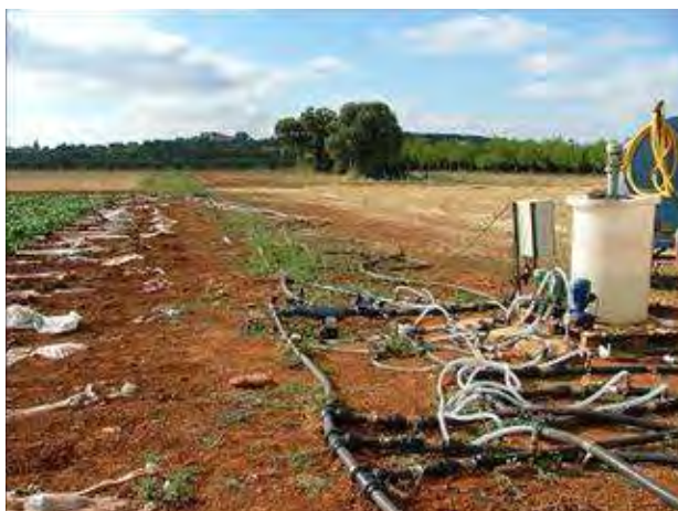
Figura 4-9. Detalle del sistema de fertilización nitrogenada utilizado en el experimento del melón.
