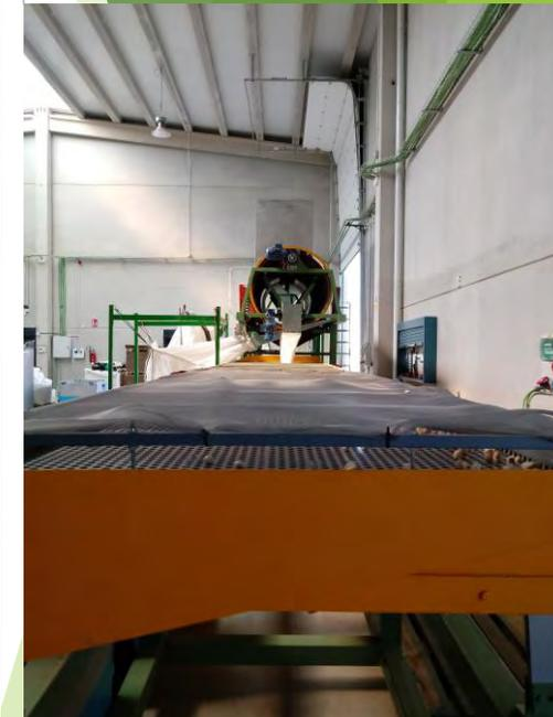
*Calibradora de cribas por vibración*
