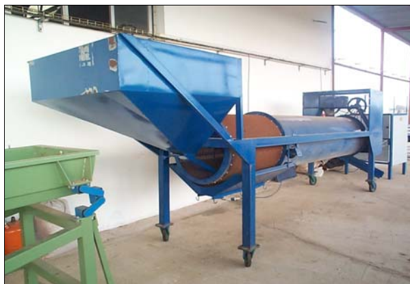
FOTO N° 12: Máquina separadora de pistachos abiertos
